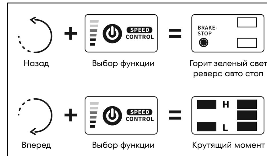
Нажмите кнопку с пометкой выбора функции на электронной панели управления сцеплением, чтобы выбрать одну из двух настроек скорости и подобрать правильный режим для конкретного случая использования.
