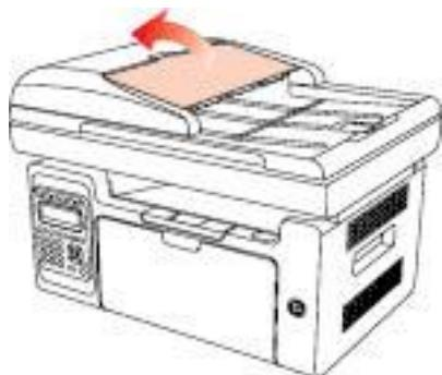
2. Загрузите оригинал в автоматическое устройство подачи документов лицевой стороной вверх так, чтобы сначала в устройство подачи входила верхняя часть оригинала.
