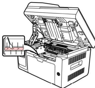
8. Очистите принтер изнутри с помощью сухой ткани, не оставляющей ворса, осторожно протерев затемненную область на рисунке ниже.
