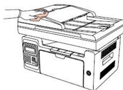
3. Поднимите крышку и осторожно протрите мягкой тканью стекло сканера.
