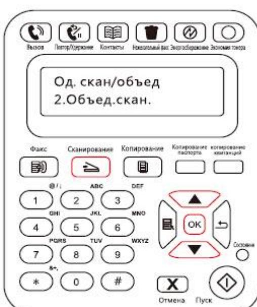
3. Нажмите кнопку "Пуск", на экране компьютера появится индикатор хода выполнения сканирования.
