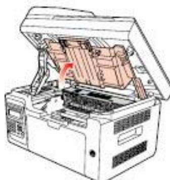
6. Выньте лазерный картридж с тонером по направляющим.
