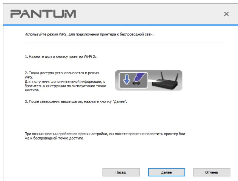
2) В соответствии с индикатором Wi-Fi принтера, определяется успешно ли соединение с принтером. Если конфигурация не удается, нажмите кнопку "Назад", реконфигурацию, если конфигурация прошла успешно, нажмите на кнопку "Готово", чтобы завершить настройку.
