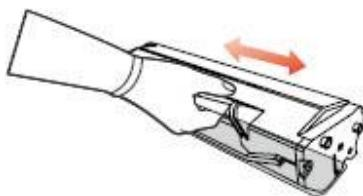
5. Выньте защитную блистерную ленту, вставьте картридж по направляющим в принтер и задвиньте его в направлении, обозначенном стрелкой, до щелчка. Щелчок означает, что картридж встал на место.
