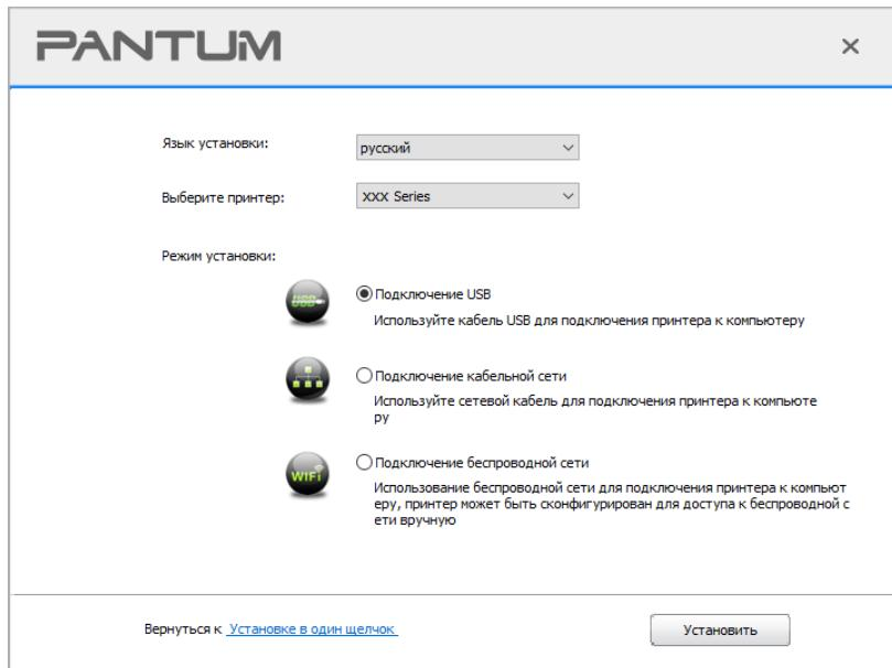
7. Программное обеспечение установит драйвер автоматически. Процесс установки может занять некоторое время. Его длительность зависит от конфигурации вашего компьютера. Пожалуйста, ожидайте.
