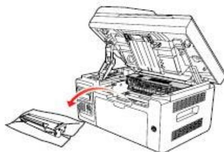
4. Откройте упаковку нового лазерного картриджа с тонером, удерживайте картридж за ручку и аккуратно встряхните его 5–6 раз, чтобы равномерно распределить тонер внутри картриджа.
