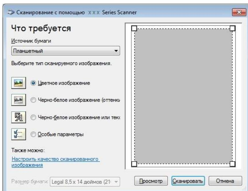
4) Нажмите "Настроить качество сканированного изображения" в левом нижнем углу вышеприведенного изображения, появится окно расширенных свойств, затем пользователи могут настроить сканирование. После завершения настройки нажмите кнопку "OK", а затем нажмите кнопку "Сканировать", чтобы начать сканирование.
