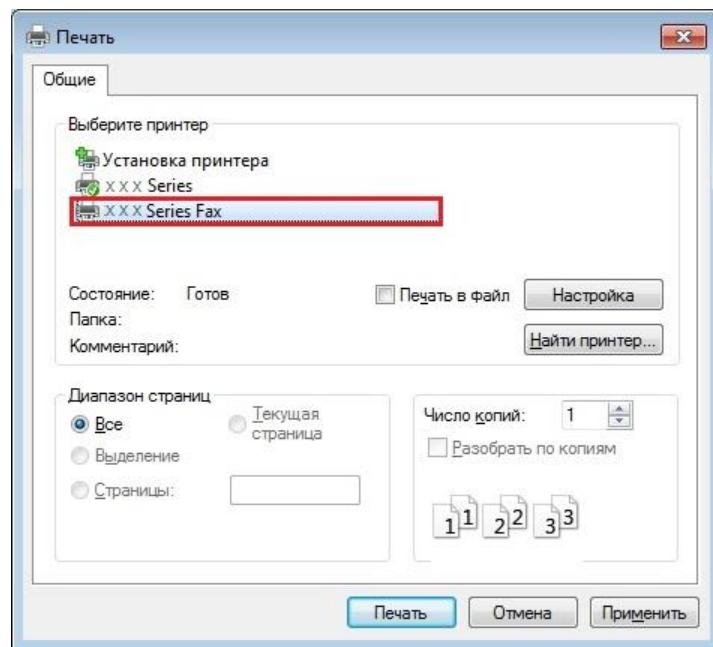
3. Выберите Pantum M6600NW Series Fax в качестве принтера, нажмите "Печать", отобразится окно "Pantum отправит факс".
