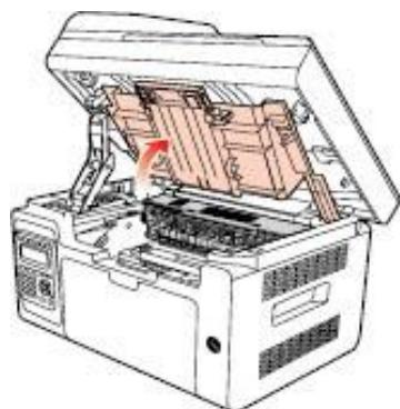
3. Выньте лазерный картридж с тонером по направляющим.
